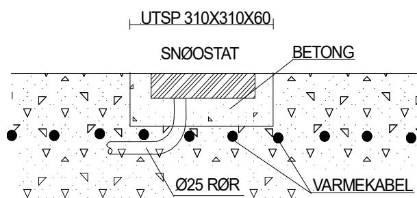
I asfalt føres røret til en forsenkning som komprimeres og kjøles litt av. Umiddelbart legges giveren på løs, varm asfalt og trykkes varsomt til den er i plan med resten av arealet.
