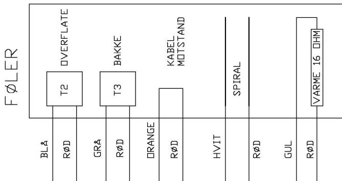
**Over fuktøleren må det monteres en kondensator 22µF 35V for å motvirke oppbygging av batterispennin.**
